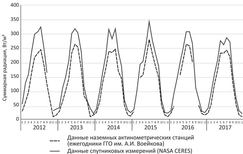
Рис. 2.12. Временной ход суммарной солнечной радиации у поверхности земли в Самаре по данным актинометрических станций и спутниковых измерений NASA (Aqua) за период 2012–2017 гг.
